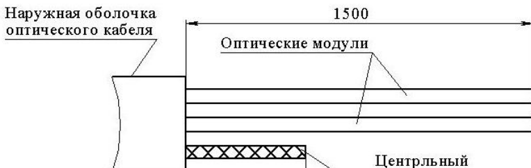
Рис.2 Разделка оптического кабеля.
