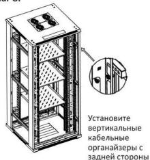
шкафа (где расположен кабельный ввод в верхней крышке), используя винты M6\*12, фланцевые гайки M6 и пластиковые шайбы M6 (12 шт.).
