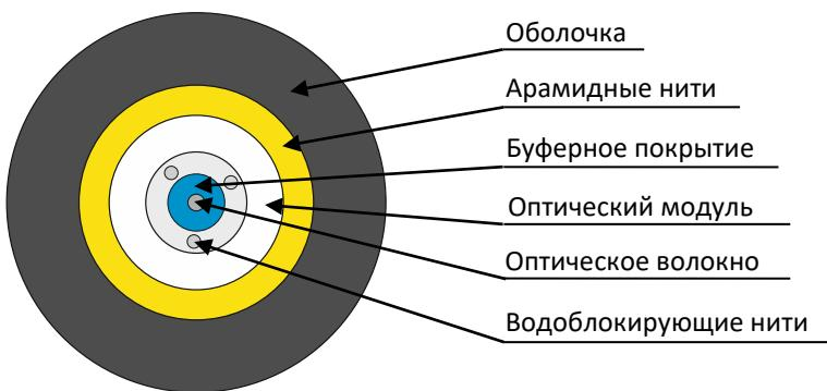
Кабель содержит одно оптическое волокно в буферном покрытии. Оптическое волокно вместе со свободно уложенными водоблокирующими нитями находится в оптическом модуле. Поверх модуля спирально накладываются упрочняющие арамидные нити и оболочка из полимерной композиции, не распространяющей горение, не содержащей галогенов с низким дымовыделением. Буферное покрытие изготавливается синим цветом. Оболочка кабеля изготавливается черного цвета, стойкой к ультрафиолетовому излучению.
