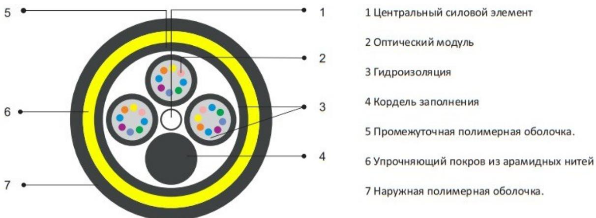
Сердечник модульной конструкции, центральный силовой элемент из диэлектрического стержня, вокруг которого скручены оптические модули со свободноложенными волокнами. Свободное пространство в оптическом модуле заполнено гидрофобным гелем. Поверх сердечника наложена дополнительная оболочка и упрочняющий покров из арамидных нитей. На защитный покров накладывается оболочка из полимерного материала.
